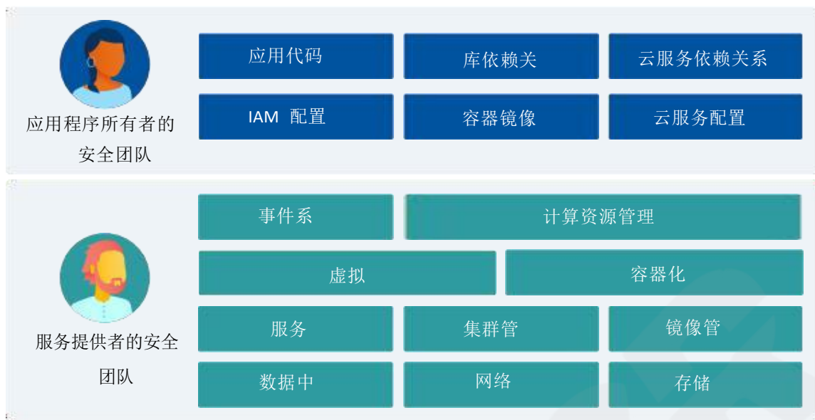
基于镜像的无服务器共享责任模型
